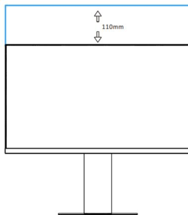
Регулировка высоты головки монитора: 0 - 110 мм
